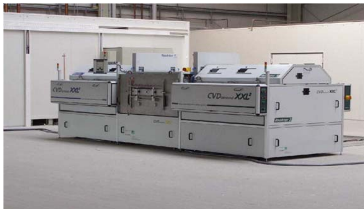
CVD-Diamantbeschichtungsanlage (CVD= Chemical Vapor Deposition) der Fa. Condias, Itzehoe
