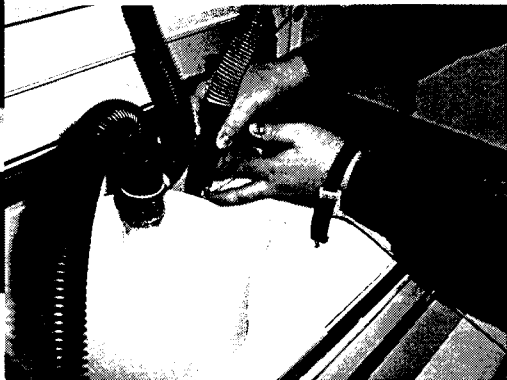
Auspacken: Nach Druck aller Schichten wird das überschüssige Pulver aus dem Bauraum gesaugt
