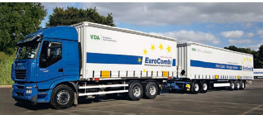
Auf europäischer sowie nationaler Ebene gibt es Überlegungen, die Lkw-größen und -gewichte zu erhöhen. Die Lkw wären 25,25 Meter lang und würden in der kleinsten Variante 40 Tonnen Gesamtgewicht wiegen.
