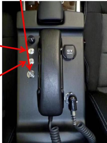
Mit dem hinteren Taster kann die hintere Kamera geschaltet werden.
