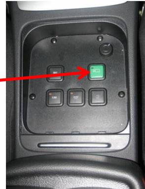
Beim Betätigen des Anhaltesignalgebers für vorn, startet automatisch die Aufnahme, zu erkennen am Blinken der LED im Taster und einem roten Punkt am Monitorrand(\*).
