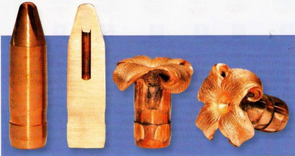
MENs Schrägflächen-Projektile bestehen aus Tombak. Die für das Deformieren nötigen Sollbruchstellen finden sich nicht in der von einem Tombakeinsatz verschlossenen Hohlspitze. Sie sind in der Mantelfläche der Spitze eingefräst.
