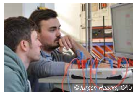
Das neue Praktikum für Lehramtsstudierende: elektrische Schaltungen und Vorgänge wie das Laden und Entladen von Kondensatoren als Unterrichtsgegenstand.
