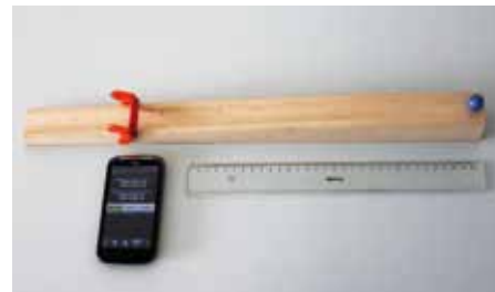
Abbildung 1: Aufbau des Experiments zur gleichmäßig beschleunigten Bewegung.
