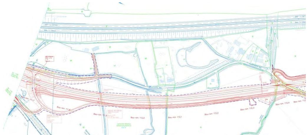
Abb. 8 Entwurf der neuen Bahnstrecke mit Anpassung / Straßenbau im Bereich Ruppertsdorfer Weg (Quelle: DB NETZE)
