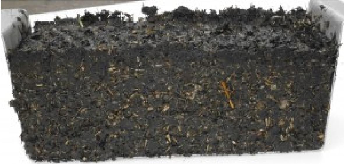
**Abbildung 7a:** Aus Faulschlamm der Schlei und Sägespäne gepresster Brikette. Auf Grund des hohen Mineralgehaltes glüht dieser allerdings im Ofen eher durch als eigenständig zu brennen. Photo: Karl Walther.
