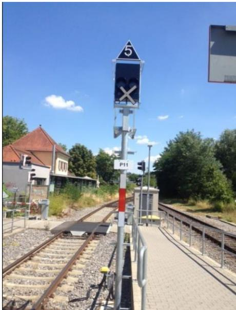
Abbildung 20: Barrierefreier, technisch gesicherter Zugang zu einem Mittelbahnsteig [Quelle: Zweckverband ÖPNV im Ammertal]
