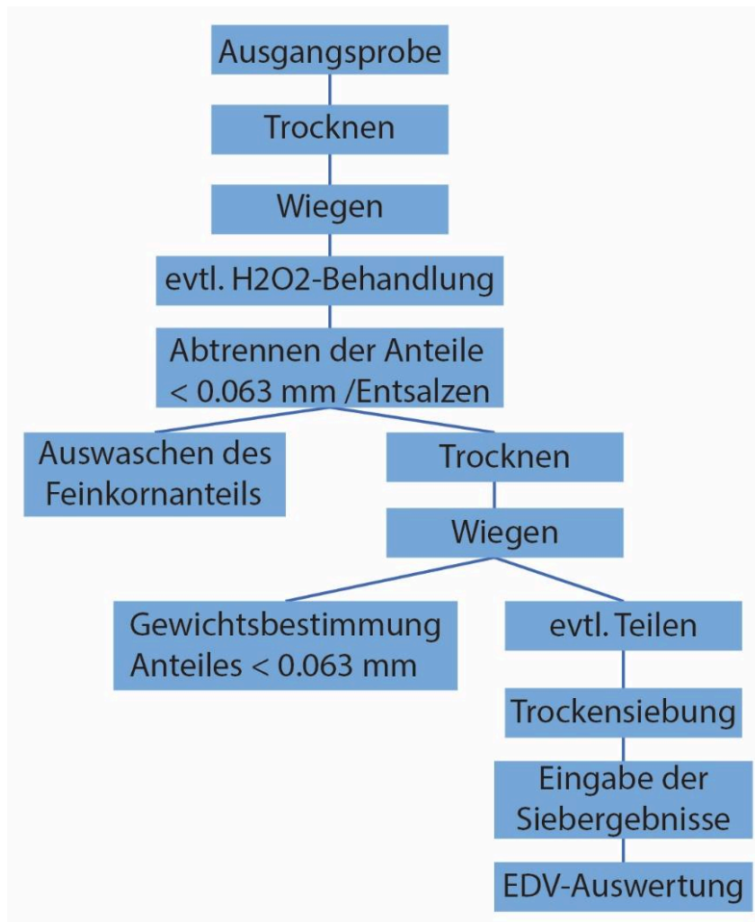
Abbildung 9: Flussdiagramm zur Bearbeitung von Siebproben.
