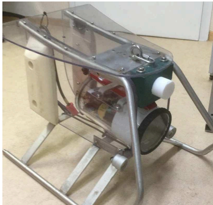
Abbildung 4: Unterwasservideoschlitten (Leihgabe des Bundesamt für Naturschutz) mit GoPro Kamerasystem.
