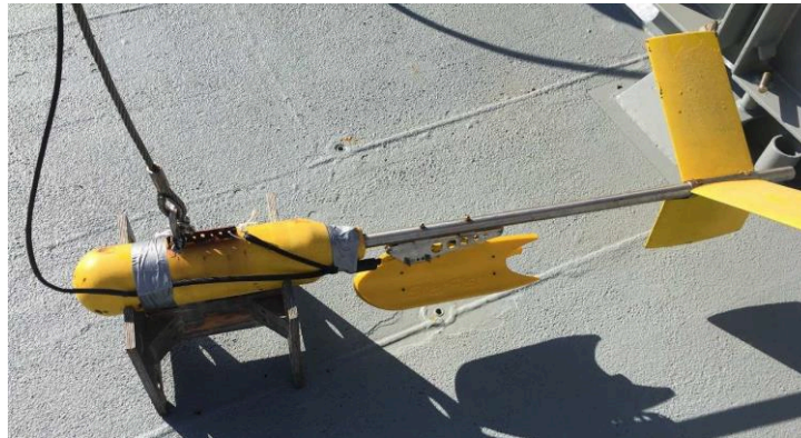
Abbildung 3: Seitensichtsonar „Starfish 452F“ in Schleppvorrichtung.
