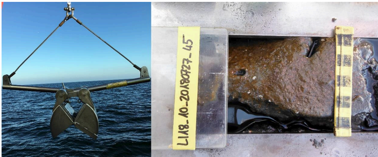
Abbildung 7: Offener (links) und gefüllter Van-Veen-Backengreifer (rechts). Die rechte Abbildung zeigt die Sedimentoberfläche mit Maßstab in cm-Einteilung sowie die Probenkodierung.
