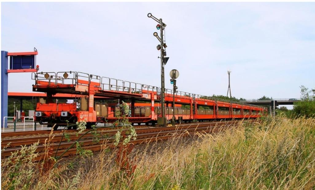
Bild 2: Doppelstock-Gelenkwagen der Bauart DD<sup>992</sup> Foto: M. Steiner
