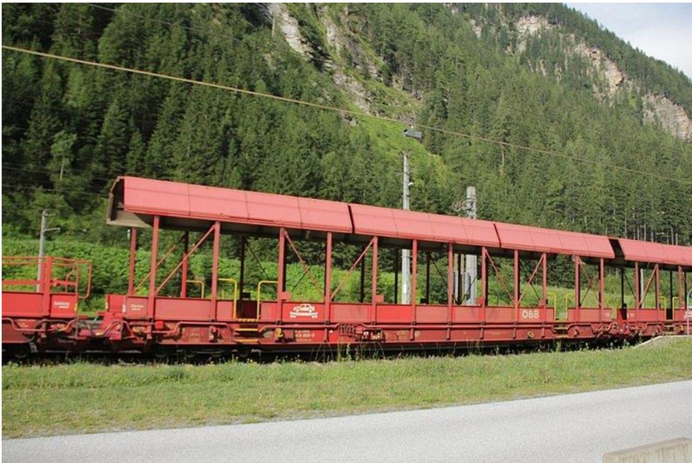
Bild 5: Transportwagen der ÖBB-Tauernschleuse
