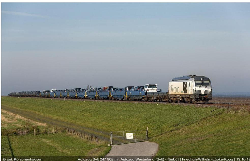
Bild 4: RDC-Autozug aus Flachwagen der Bauart Res Foto: Körschenhausen
