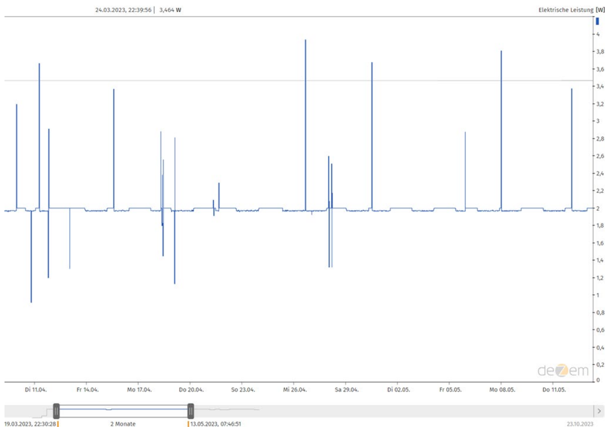
Abbildung 13: Leistungsaufnahme eines Smartboards über den Messzeitraum
