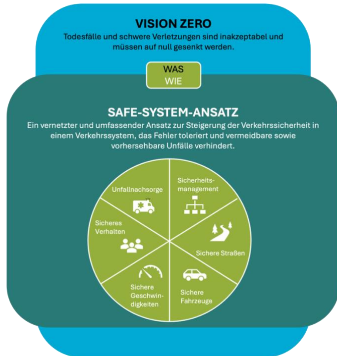
Abbildung 2: Safe-System-Ansatz. (Eigene Darstellung nach "Vision Zero and the Safe System Approach: A Primer for Canada" (TAC 2023))
