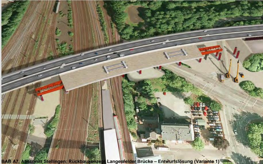
BAB A7, Abschnitt Stellingen: Rückbaukonzept Langenfelder Brücke – Entwurfslösung (Variante 1)
