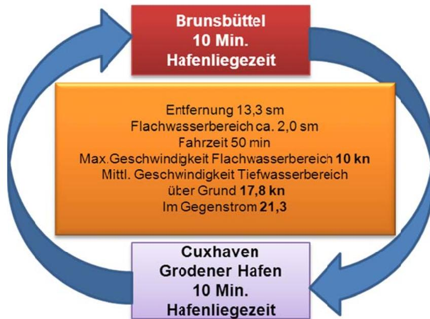
Abbildung 6: Zusammenhang zwischen hydromechanischen Einflüssen, Länge der Seereise und erforderlicher Geschwindigkeit bei vorgegebener Rundreisezeit von 2 Stunden für die Route Brunsbüttel-Grodener Hafen
