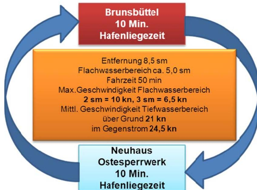
Abbildung 4: Zusammenhang zwischen hydromechanischen Einflüssen, Länge der Seereise und erforderlicher Geschwindigkeit bei vorgegebener Rundreisezeit von 2 Stunden für die Route Brunsbüttel-Ostesperrwerk
