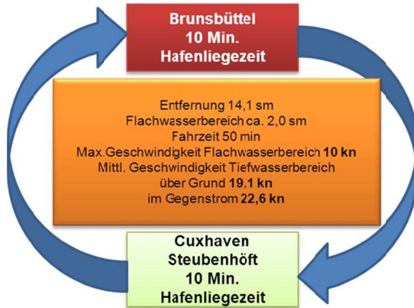
Abbildung 5: Zusammenhang zwischen hydromechanischen Einflüssen, Länge der Seereise und erforderlicher Geschwindigkeit bei vorgegebener Rundreisezeit von 2 Stunden für die Route Brunsbüttel-Steubenhöft
