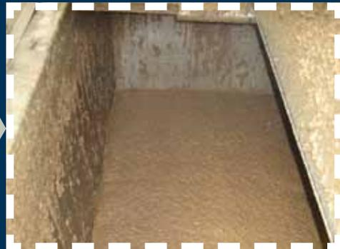
Das **DRM - Hybrid Verfahren** beinhaltet eine nasse Stoffaufbereitung, die auf einfache Weise anorganische Feststoffe (z.B. Verpackungen) und organische Fraktionen mit unterschiedlichen Trockensubstanz- Gehalten synchron in einem Arbeitsgang aufschließt und separiert.
