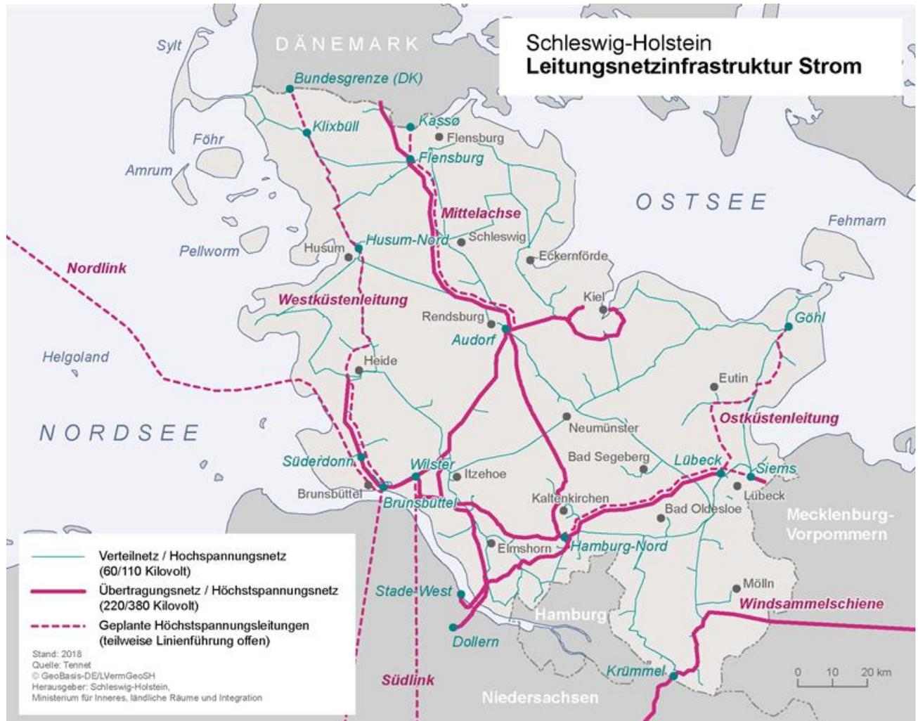
Abbildung 28: Energienetze Elektro in Schleswig-Holstein: Übertragungs- und Verteilnetz [Quelle Tennet 2018]
